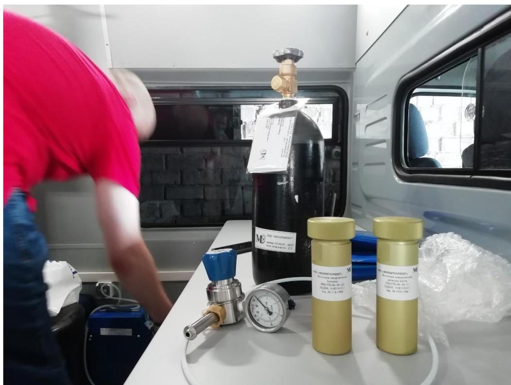
Рисунок Ж.15 — Калибровка ПЭЛ по аммиаку и диоксиду азота
