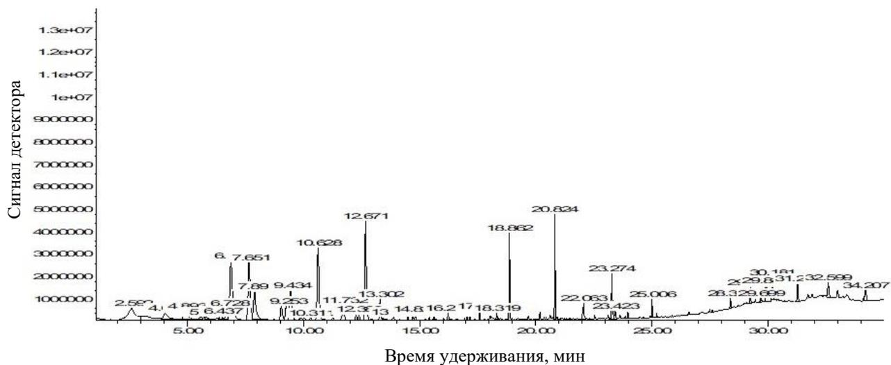
Рисунок 21 — Хроматограмма пробы воздуха, отобранной на трубку ТА2 (ул. 50 лет Октября, 48), с пиками, обладающими большим откликом детектора и идентифицированные как *транс*-дец-3-ен (6.728 мин), бутилацетат (7.651 мин), *о*-ксилол (10.628 мин), стирол (12.671 мин), бензальдегид (18.862 мин), ацетофенон (20.824 мин)
