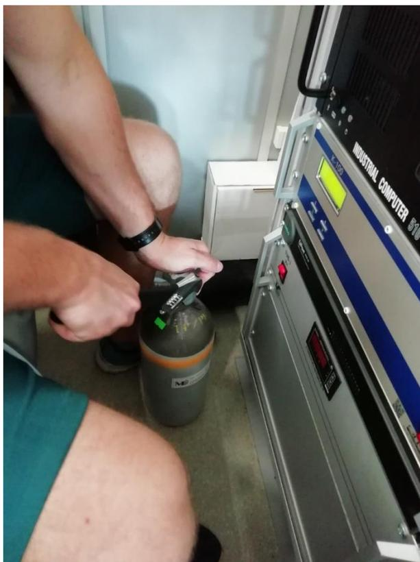
Рисунок Ж.16 — Калибровка ПЭЛ по баллону ПГС
