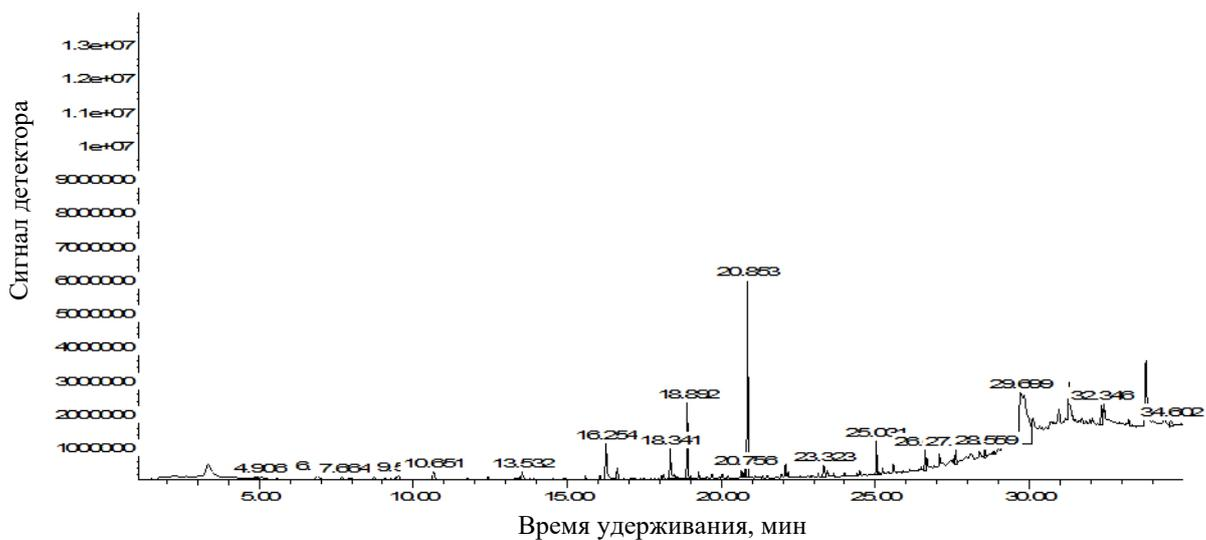
Рисунок 24 — Хроматограмма пробы, отобранной по адресу ул. Льва Толстого, 12 с пиками, обладающими большим откликом детектора и идентифицированные как бензальдегид (18.892 мин) и ацетофенон (20.853 мин)
