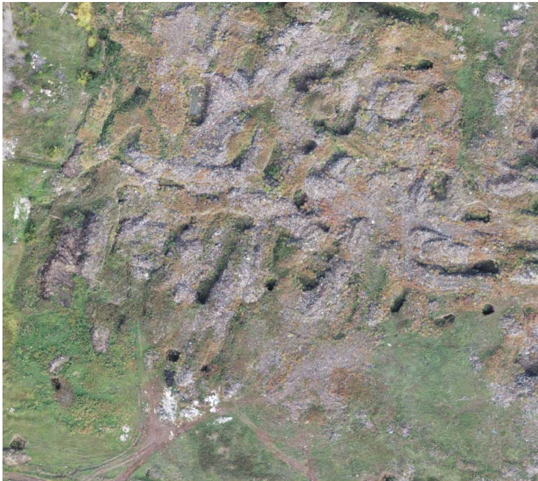
Рисунок 2.3 - участок намечаемой хозяйственной деятельности – нарушенная («вскрытая») поверхность ранее рекультивированной свалки, вид сверху
