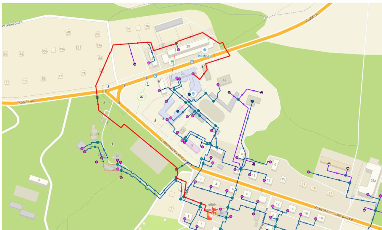
Рисунок 2.25 - Путь теплоносителя по направлению от котельной №14 до потребителя «ул. Комзина 4»
