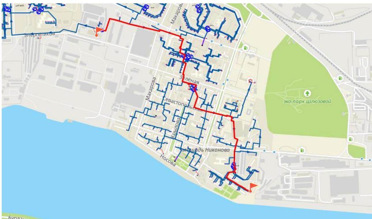
Рисунок 2.33 - Путь теплоносителя по направлению от котельной №8 до потребителя «ул. Никонова,38»
