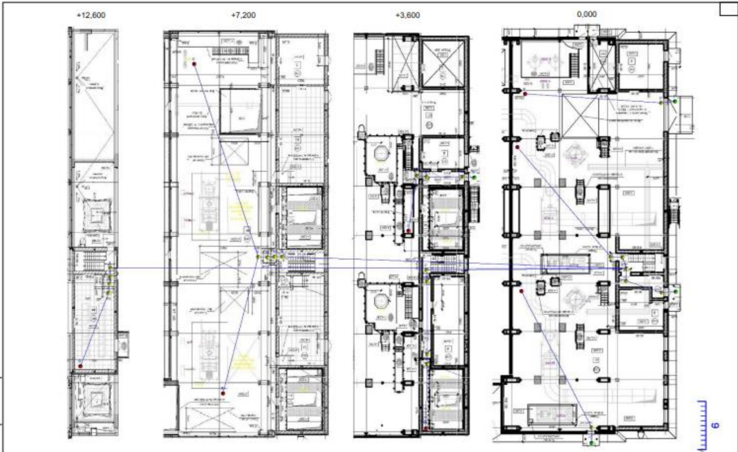
Рисунок 14. Расчетная схема эвакуации из корпуса 628 при пожаре в помещении 101
