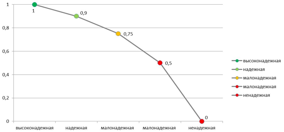
Рисунок 1 – Показатели степени надежности системы теплоснабжения
