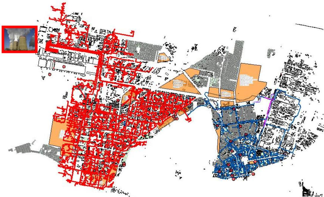
Рисунок 18 – Зона теплоснабжения ТЭЦ ВАЗа
