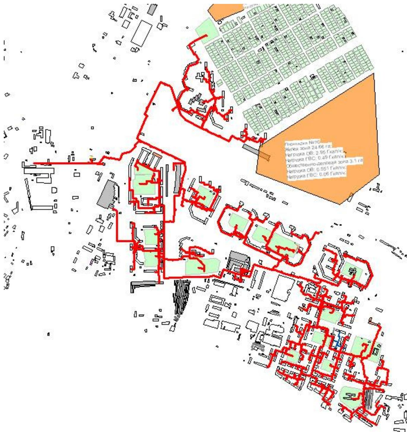
Рисунок 56 – Тепловая сеть от Котельной № 8
