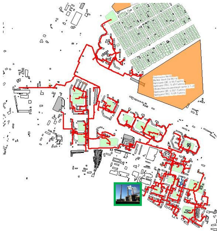
Рисунок 21 – Зона теплоснабжения Котельной № 8
