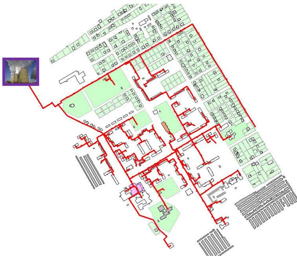
Рисунок 19 – Зона теплоснабжения котельной БМК-34
