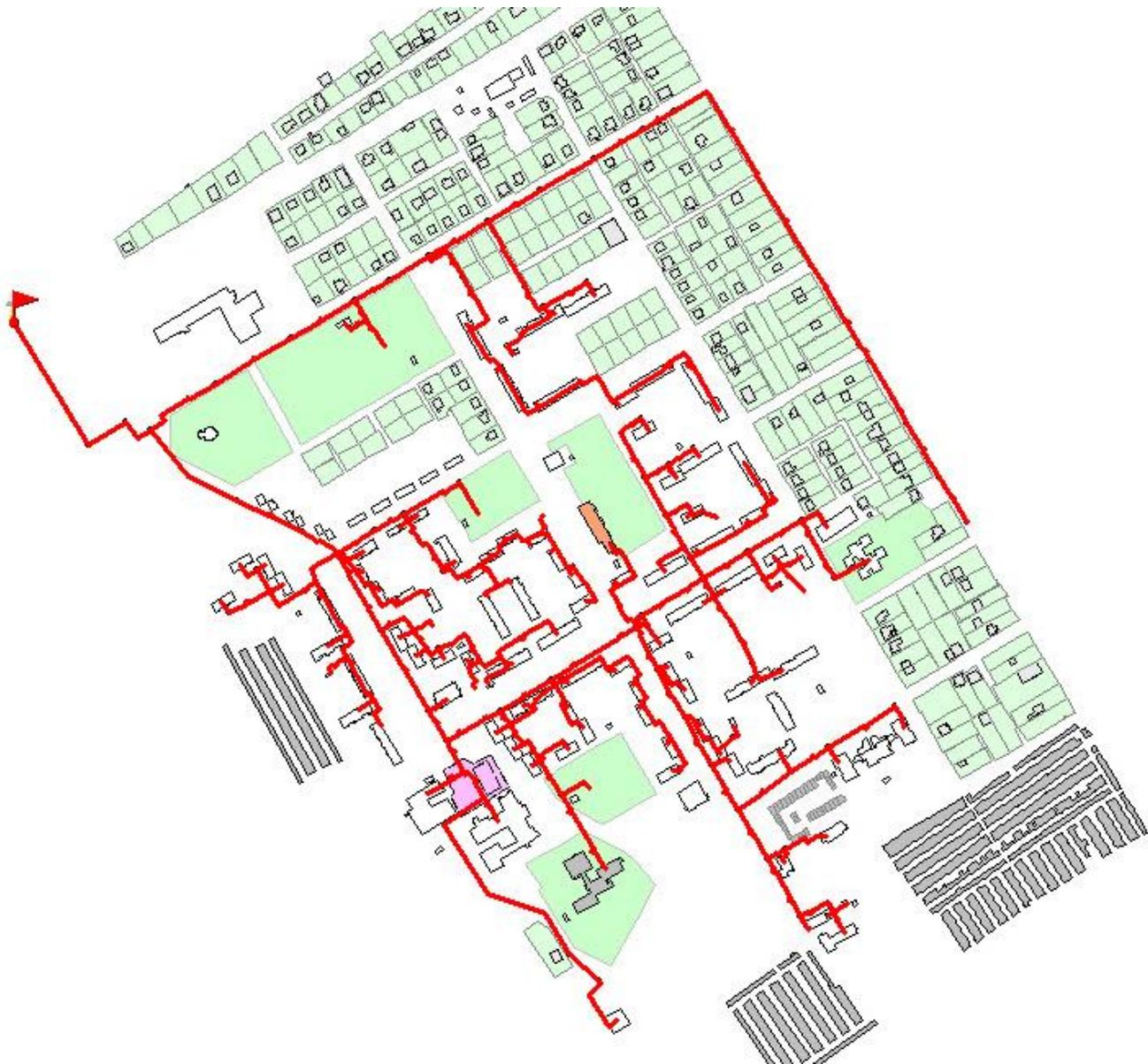
Рисунок 44 – Тепловая сеть от котельной БМК-34
